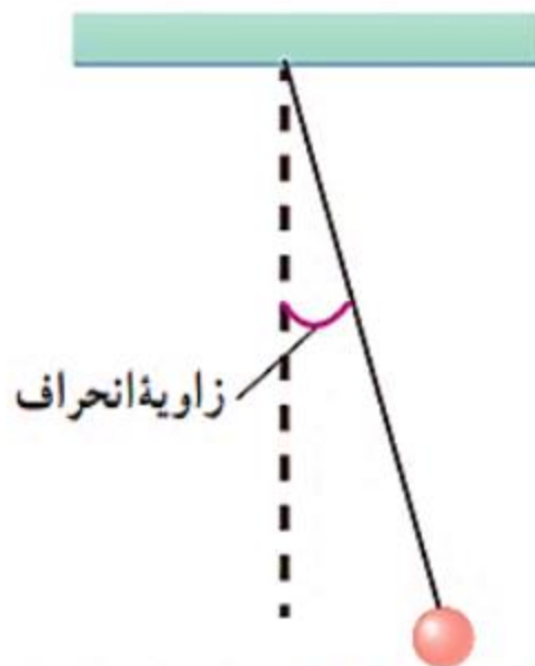
شکل ۳-۸ آونگ ساده، شامل وزنه ای کوچک است که از نخي بدون جرم و کش نیامدنی آویزان است.
