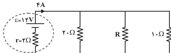
۵۴- در شکل زیر اگر اختلاف پتانسیل دو سر مجموعه مقاومت‌ها مقدار ثابتی باشد، توان الکتریکی مصرفی در مقاومت  $R_2$  چند برابر توان
