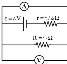
۶۹- در مدار شکل مقابل، ولت‌سنج آرمانی و آمپرسنج آرمانی به ترتیب چند ولت و چند آمپر را نشان می‌دهند؟
