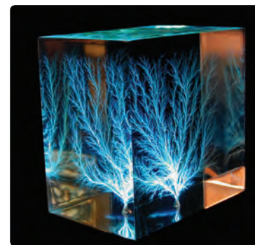
شکل ۱-۴۵ نقش‌های لیچنبرگ. فروریزش الکتریکی باعث تشکیل مسیرهای رسانشی سرخس شکلی در دی الکتریک شده است.
