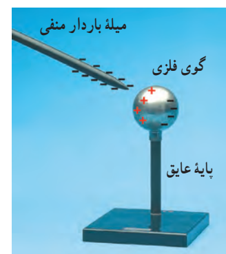
شکل ۲۹- بار اضافی داده شده به یک رسانا در سطح خارجی آن توزیع می‌شود.
