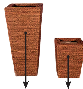
شکل ۲-۲ گاهی برای سادگی فرض می‌شود که همه جرم یک جسم در یک نقطه به نام مرکز جرم جسم متمرکز شده است و به‌جای آنکه نیرو به قسمت‌های مختلف جسم وارد شود به این نقطه وارد می‌شود.
