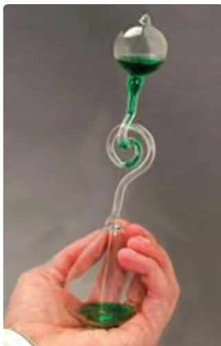
شکل ۴-۳۸ با در دست گرفتن حباب شیشه‌ای و گرم کردن آن، مایع رنگی در لوله ماریج بالا می‌رود.
