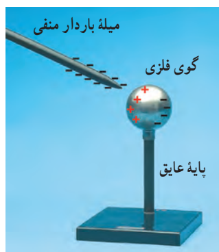
شکل ۱-۲۷ نزدیک کردن میله باردار منفی به گوی فلزی خنثایی که روی پایه عایقی قرار گرفته است، موجب ایجاد بارهای القایی مثبت و منفی در دو طرف گوی فلزی می‌شود.
