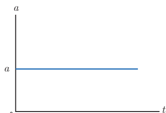
شکل ۱۳-۱ نمودار a-t در حرکت با شتاب ثابت با فرض مثبت بودن a
